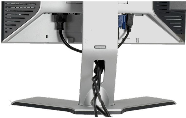
將所有必要的連接線連接至顯示器與電腦之後，（請參見[連接您的顯示器](#)以取得連接線的連接資訊，）請如上圖所示使用連接線固定器來將連接線整理乾淨。
